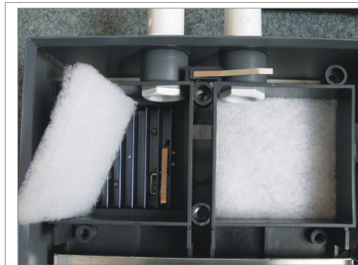
Bilde 7 – Filter og varme-elementer
